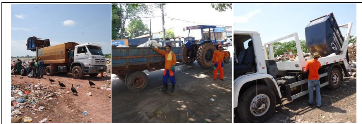
Fig. 14: Veículos para coleta de RSU em Castanhal: compactador, carroça com trator, poliguindaste com caixa Brooks (esq. à dir.), caçamba (fig. 12) (BRENCORP, 2012)
